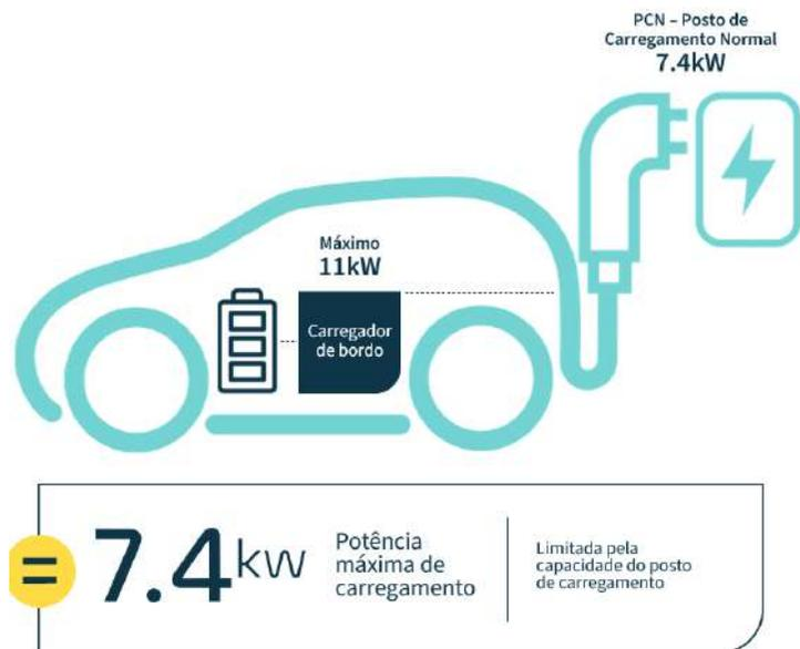
Num Posto de Carregamento Normal de 7.4 kW, só carregará a uma potência máxima de 7.4 kW. Ou seja, ainda que veículo permita velocidades de carregamento superiores, estamos sempre limitados pela capacidade de carregamento.
