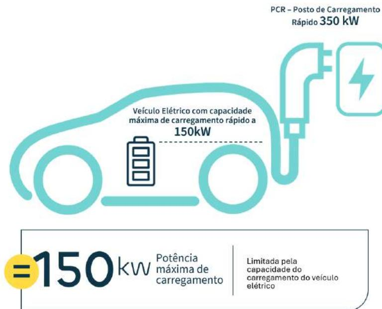
Um veículo elétrico, com a capacidade máxima de carregamento rápido até 150 kW, ao carregar num Posto de Carregamento Rápido de 350 kW, só carrega à potência máxima que o veículo permite, ou seja, a 150 kW.
